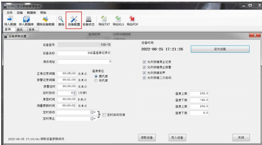
编辑完设备参数后，点击“写入设备”，即可把参数写入到记录仪中。
