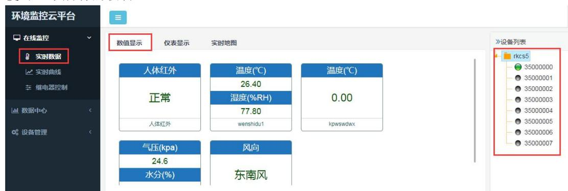
单击“仪表显示”按钮便可切换到仪表显示界面，在此界面可方便的显示每个节点的上限值下限值，及仪表盘测量范围。
