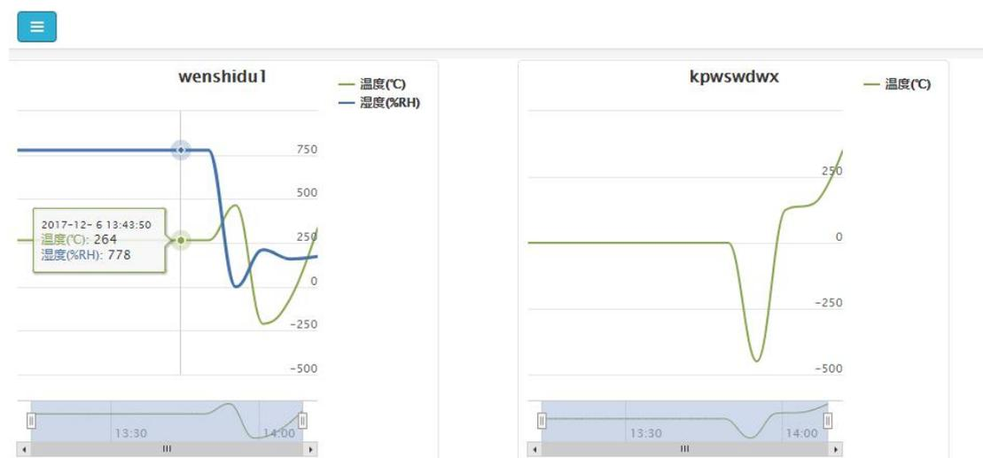
选择实时曲线模式查看，然后在设备列表中选择对应的设备，平台便可自动显示就近一个小时的数据。鼠标放到曲线上时，会显示对应时间点的温度和湿度数据。在下方时间轴，可选择任意时段对数据进行放大或精确分析。
