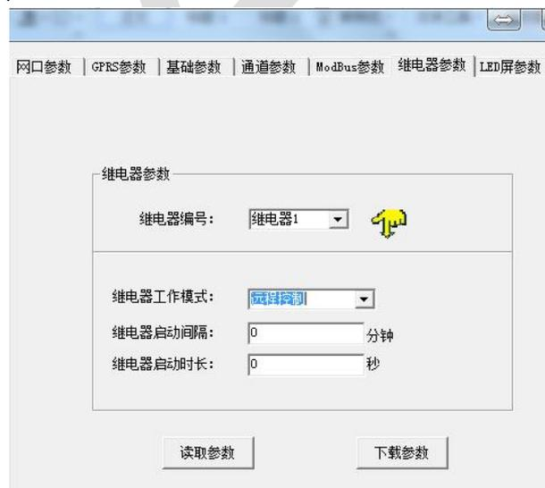
继电器参数标签页主要设置监控主机继电器的工作模式。监控主机自带两路继电器，编号分别是继电器 1 和继电器 2。若监控主机外接 1 台我公司 RS-M88 工控模块，则 M88 工控模块的 8 路继电器编号为继电器 1~继电器 8，自带的两路继电器编号仍为继电器 1、继电器 2，此时监控主机的继电器 1 和 M88 工控模块的继电器 1、2 会同时动作。
