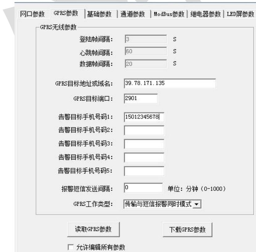
选择 GPRS 参数选项卡，单击“读取 GPRS 参数”按钮，可将参数读取到软件界面，用户可以修改参数，单击“下载 GPRS 参数”可将参数下载到设备中。
