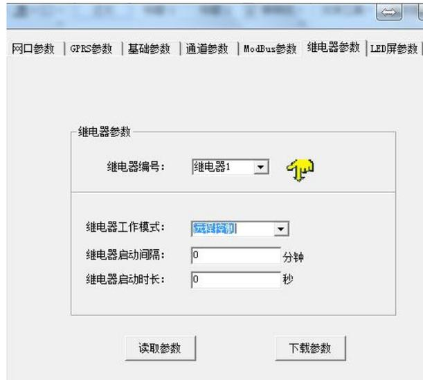
继电器参数标签页主要设置监控主机继电器的工作模式。监控主机自带两路继电器，编号分别是继电器 1 和继电器 2。若监控主机外接 1 台我司 RS-M88 工控模块，则 M88 工控模块的 8 路继电器编号为继电器 1~继电器 8，自带的两路继电器编号仍为继电器 1、继电器 2，此时监控主机的继电器 1 和 M88 工控模块的继电器 1、2 会同时动作。
