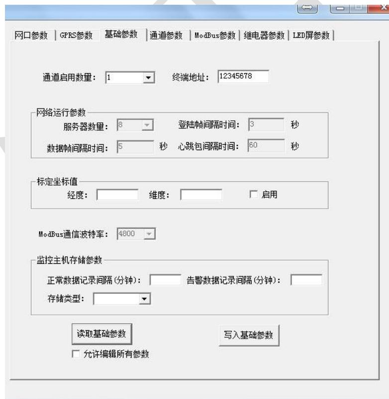
点击“读取基础参数”按钮便可将设备参数读取到界面上来，修改通用参数后，点击“配置基础参数”按钮便可将参数下载到设备中。
