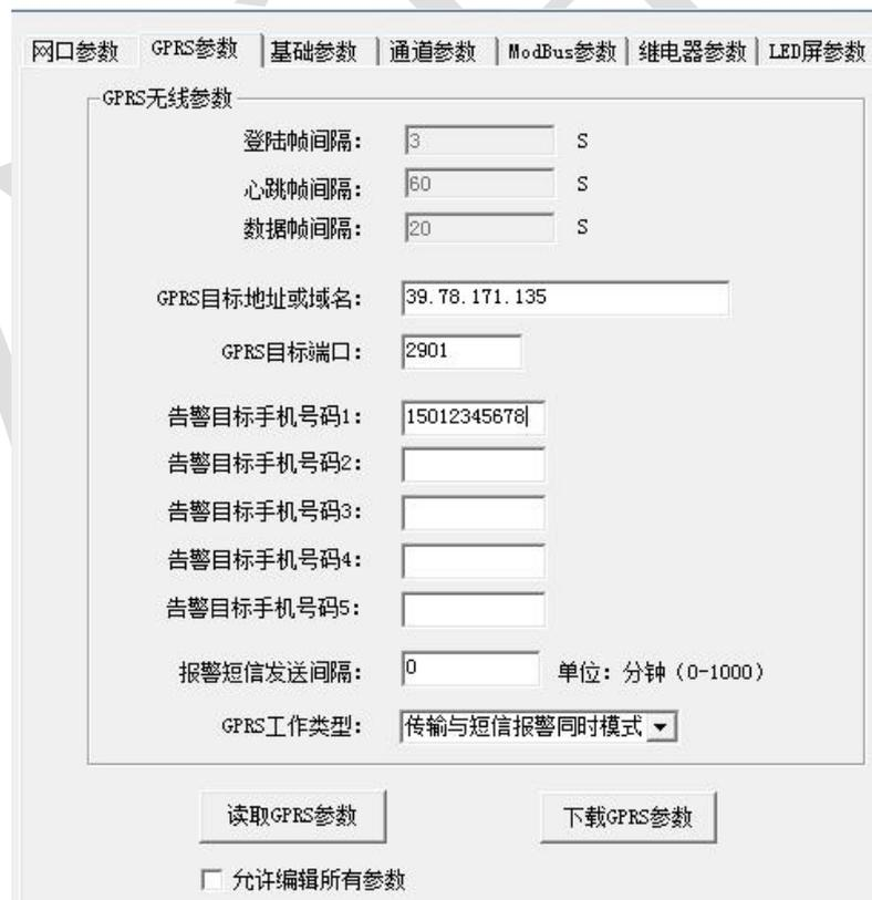
选择 GPRS 参数选项卡，单击“读取 GPRS 参数”按钮，可将参数读取到软件界面，用户可以修改参数，单击“下载 GPRS 参数”可将参数下载到设备中。
