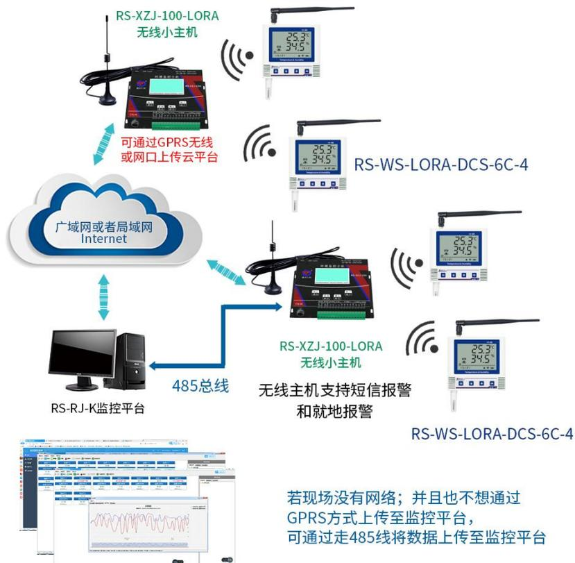
平台 2: 云监控平台。若 RS-XZJ-100-LORA 小主机上送数据至我司的云监控平台, 设备的设置是最简单的, 客户无需自建服务器, 只需要将设备插上网线, 配置一下本地网络参数即可。
