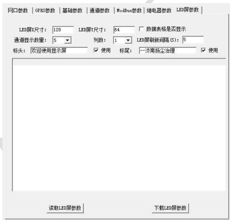
此选项卡为监控主机外接 LED 屏时，屏幕显示控制参数。
