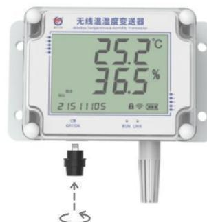
将设备安装在指定位置后，用户需自行将保险丝放入管座并安装至指定接口处，安装成功后设备已经处于上电状态。
