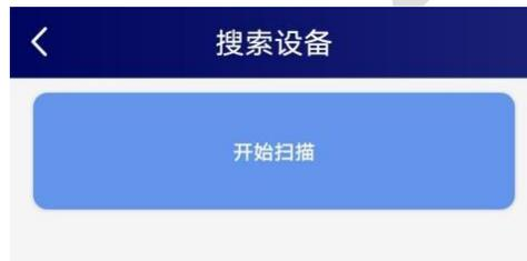
(3) **设备长按设置键**，屏幕显示蓝牙标识，表示进入蓝牙配置模式。点击“开始扫描”搜索需要配置的设备，设备名称为 WIFIC4 加设备地址，例设备地址为 FFFFFFFF，选择 WIFIC4-FFFFFFFF 即可。
