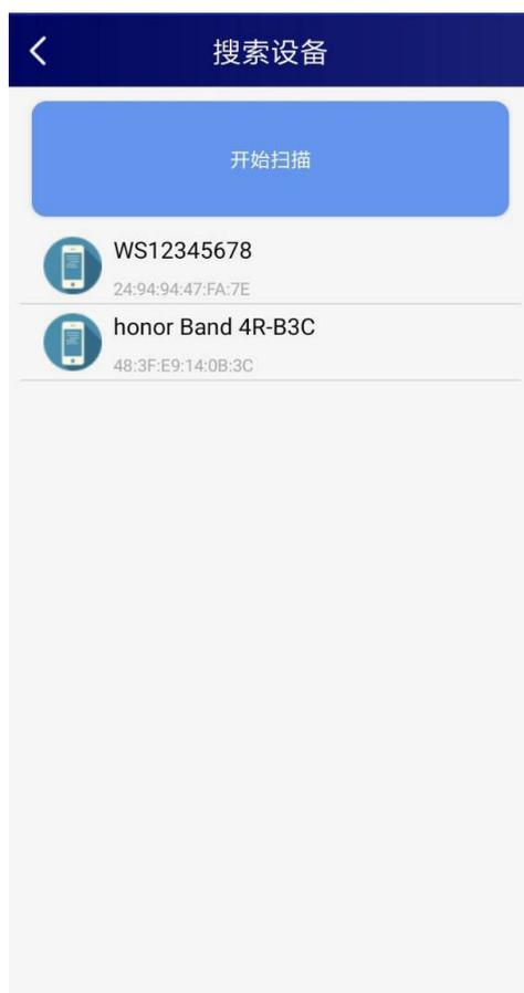
(3) 点击密码输入框，输入设备密码（默认密码 12345678），进入到设备配置页面。设备左下角显示“CONN”，表示连接成功。
