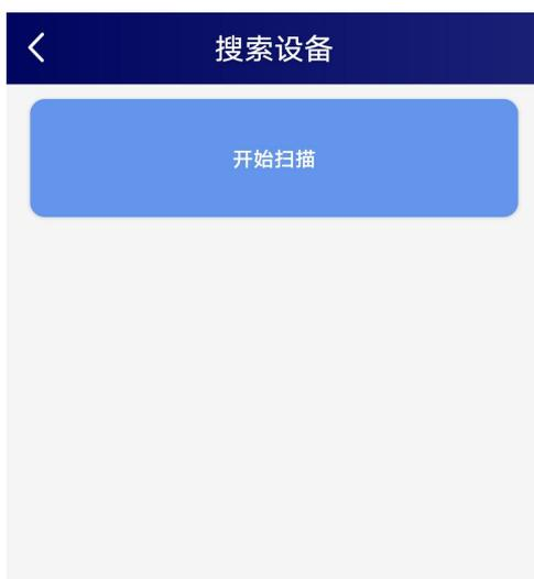
(2) 设备长按 **OK** 键，左下角显示“DISC”，表示进入蓝牙配置模式。点击“开始扫描”搜索需要配置的设备，设备名称为 WS 加设备地址，例设备地址为 12345678，选择 WS12345678 即可。
