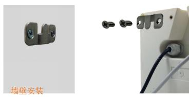
首先将挂钩一面使用沉头螺钉安装到墙壁上,方向如图所示,另一面如图所示使用螺 丝钉安装到设备上,然后将两部分挂到一起即可。
