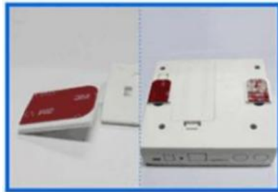
1. 将壁挂扣安置在壁挂孔上
