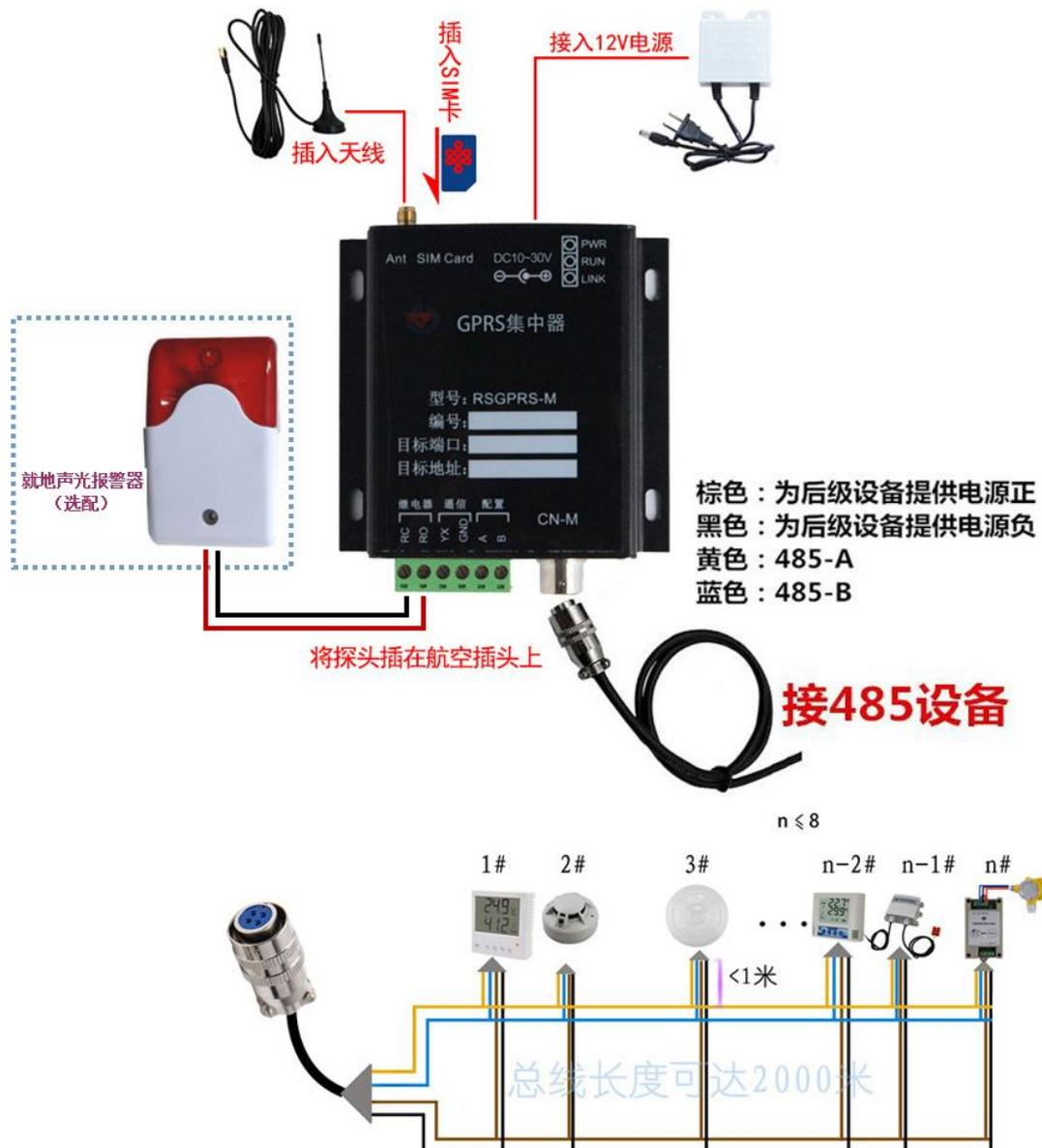
将专用的吸盘天线拧上, 将SIM卡按图示方向插入卡槽, 将航空插头线缆与RS485变送器连接好, 并插入CN-M接口, 根据需要接入声光报警器, 给设备上电, 设备便可将数据上传至局域网内或者广域网的监控平台了。
