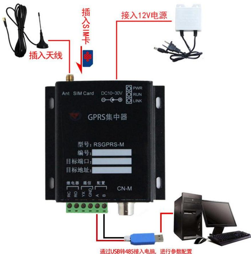
将专用的吸盘天线插入设备, 将SIM卡插入设备, 4芯航空插头线缆可以接入, 也可不接, 若选配了声光报警器, 按图所示接入声光报警器, 将USB转485转换头与设备的配置A和B连接如图所示然后连接电脑, 在电脑上安装USB转485转换头的驱动, 然后便可通过电脑对设备进行配置了, 配置完毕后设备便可将数据上传至局域网内或者广域网的监控平台了。
