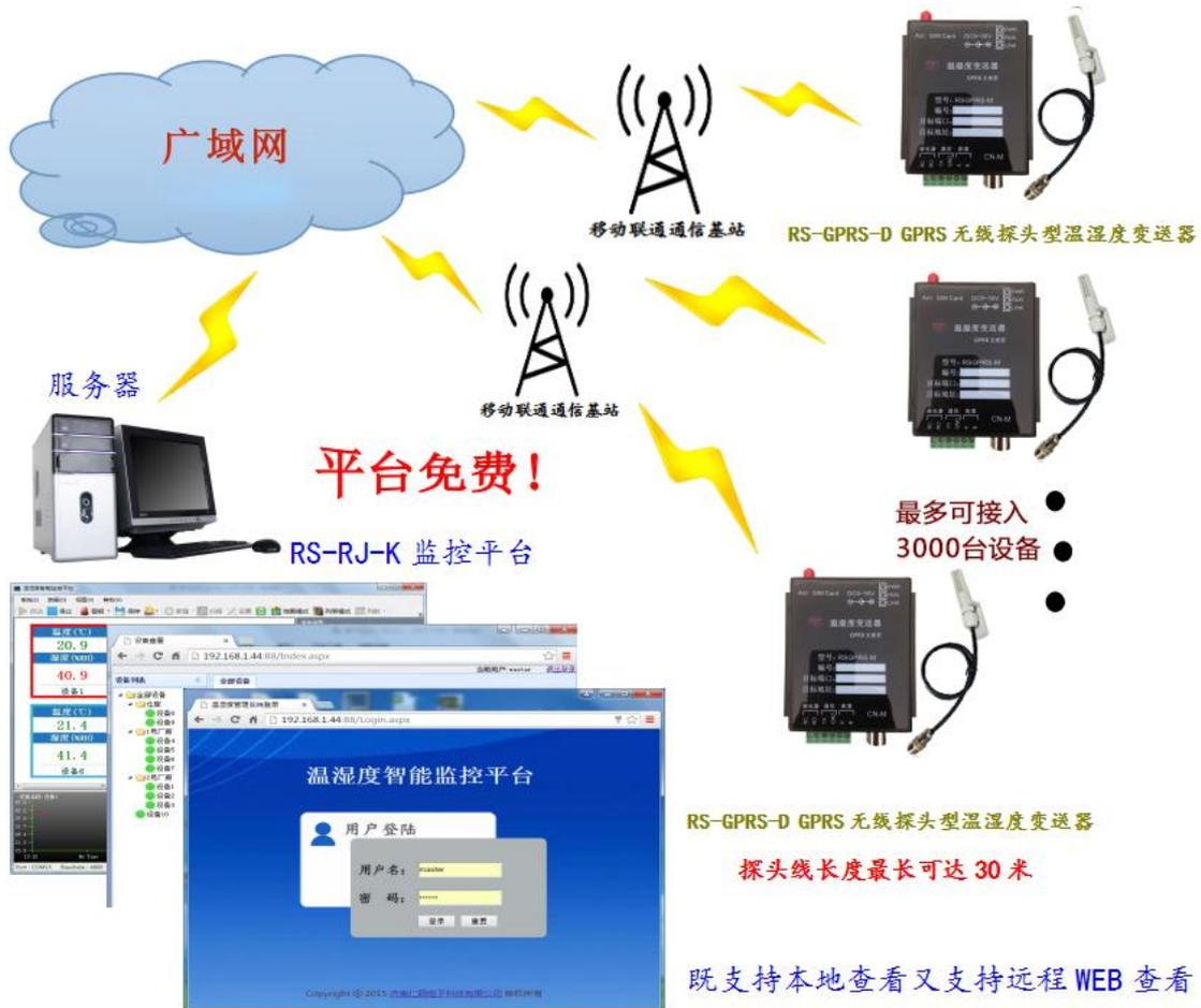
平台 2: 环境监控云平台。若 RS-GPRS-D GPRS 无线探头型温湿度变送器上送数据至本公司的云监控平台, 设备的设置是最简单的, 客户无需对产品做任何配置, 只需要将设备插上天线及手机卡然后给设备供电即可。
