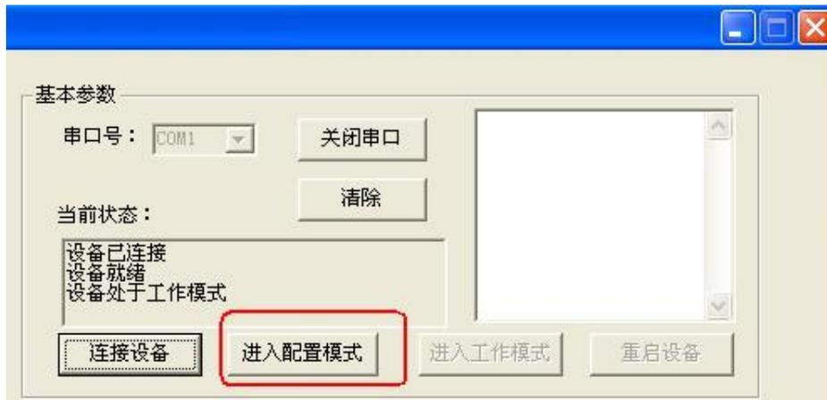
4) 点击“进入配置模式”按钮，设备会弹出进入配置模式成功或失败的窗口，设备进配置模式后，其余功能按钮会自动解锁，可自由进行参数配置，一般配置过程是先读取参数然后修改后进行配置。
