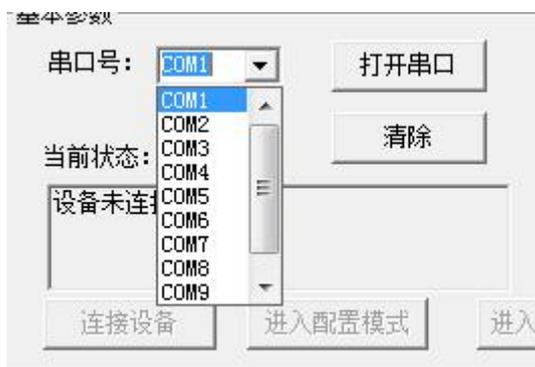
串口号此处应该选取我们提供 USB 转换模块所提供的串口，此处可在设备管理器中查看，具体步骤为：右击“我的电脑”选择“管理”，然后选择“设备管理器”找到“端口”，确认串口号。
