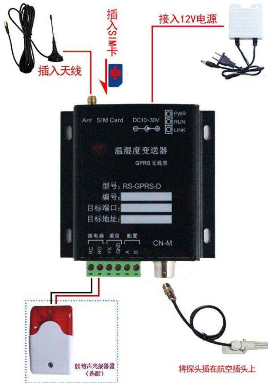
将专用吸盘天线插入设备，将SIM卡按图示方向插入卡槽，将温湿度探头插入CN-M接口插好，根据需要接入声光报警器，给设备上电，设备便可将数据上传至局域网内或者广域网的监控平台了。
