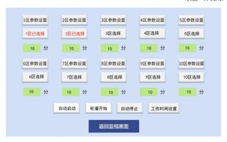
点击灌溉区上方对应的参数设置,可设置每条灌溉渠不同的需求,例如:设置流量保护上限、是否启用流量保护、搅拌选择,施肥时长的设置。
