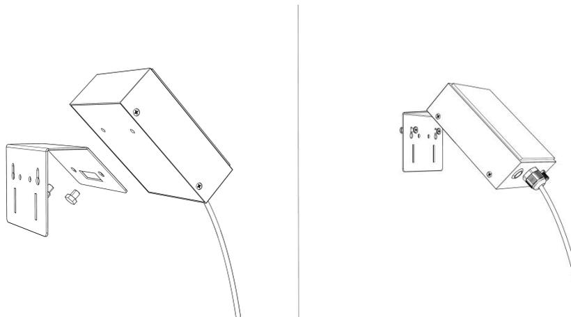
取无线脉冲式雨量计采集器壁挂抱杆配件，从螺丝包取出两枚 M5 螺丝将配件安装到无线脉冲式雨量计采集器背面两个安装孔
