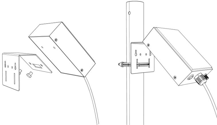
取无线脉冲式雨量计采集器壁挂抱杆配件，从螺丝包取出两枚 M5 螺丝将配件安装到无线脉冲式雨量计采集器背面两个安装孔，后续将组转完成的设备使用喉箍安装到立杆上即可。
