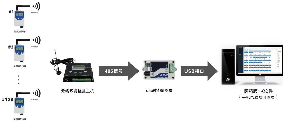
此方案中接收主机最多可以管理 128 个测点，测点通过无线传输方式将缓存数据传输至接收主机，接收主机通过 485 通讯方式将已缓存的无线测点的数据上传至我公司的-M 软件。通过软件可以将测点数据导出。
