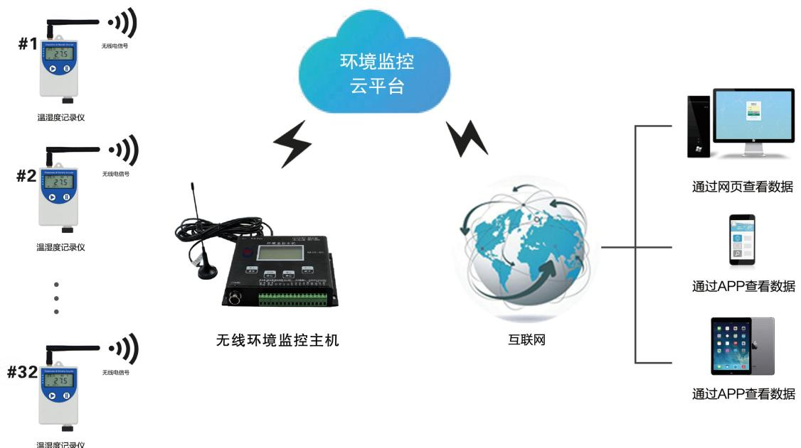
此方案一台无线主机最多可以管理 32 台无线测点，测点通过无线电通讯上传缓存数据给小主机，小主机通过网口上传至我公司的云平台。
