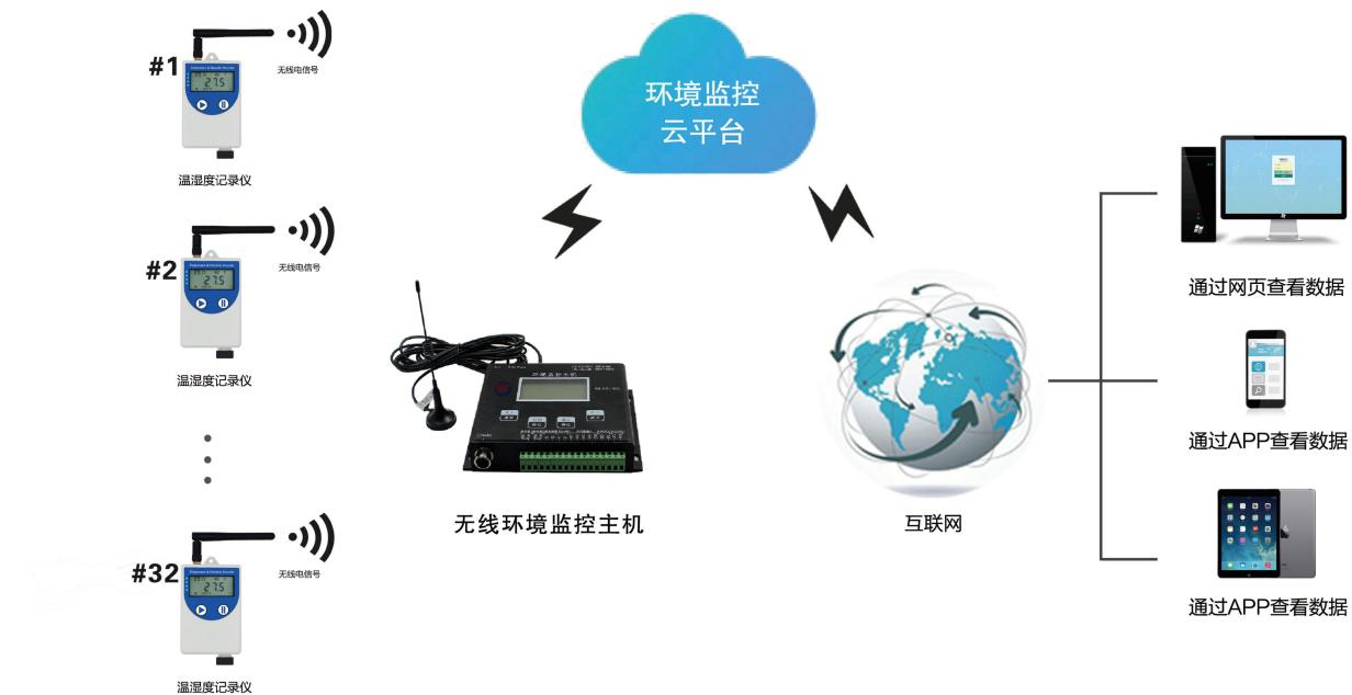
此方案一台无线主机最多可以管理 32 台无线测点，测点通过无线电通讯上传缓存数据给小主机，小主机通过网口上传至我公司的云平台。
