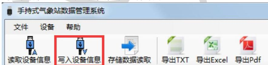
注意：在修改好的参数后面，修改参数打钩，然后再点击写入设备信息，该项参数才会被写入设备，此功能是为了方便在修改个别参数时，误修改其他参数而设置。
