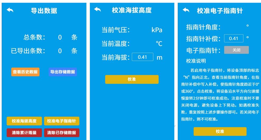
点击校准电子指南针可进入电子指南针校准界面，此界面可显示当前电子指南针角度，可选择是否启用电子指南针。校准前请仔细阅读校准说明：若启用电子指南针，将设备顶部的标志“N”指向正北，查看当前指南针角度，在指南针补偿中写入补偿，使指南针角度趋近于 $0^{\circ}$ 或 $360^{\circ}$ ，点击校准，将设备沿水平方向匀速缓慢旋转2分钟即可校准成功。注意校准时不要关闭电源，避免设备上下晃动。如遇校准失败，重复按照上述步骤操作即可。若关闭电子指南针，则不可校准。
