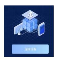
点击"连接设备",进入到扫描设备页面。拧入玻璃管保险丝,打开设备,设备第一次 上电将开启蓝牙,如果一分钟内没有连接蓝牙,或连接蓝牙后一分钟内没有任何操作,设备 将关闭蓝牙,需拧下玻璃管保险丝,等待 5 秒后重新上电,设备才可以重新开启蓝牙
