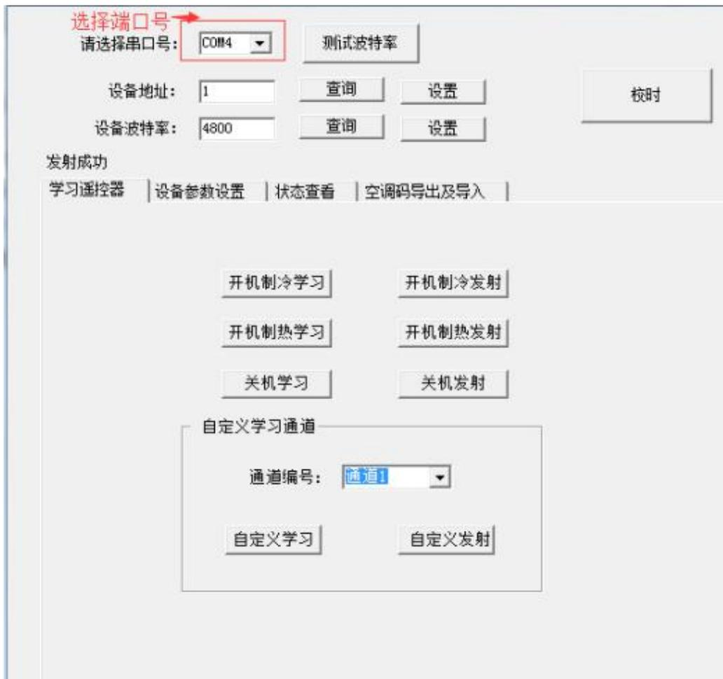
7) 将空调遥控器设置为制冷模式，关机，然后点击“开机制冷学习”按键，“红外学习发射指示灯”会 1 秒闪一次，持续闪 20s，用户必须在 20s 之内进行学习，学习指令时要把被学习设备的红外发射头对准学习设备的“红外学习接收口”，软件上会显示倒计时。在 20s 以内将空调遥控器的发射灯对准 RS-KTCF-N01 的发射灯，间距 5cm 以内。然后按空调遥控器的“开机/关机”按键。若学习成功则“红外学习发射指示灯”会快闪 5 下，蜂鸣器会响一声，软件会提示学习成功，否则提示学习失败，学习失败蜂鸣器会响两声。若学习失败，请再次点击“开机制冷学习”按键重复上面操作。若学习成功，将 RS-KTCF-N01 设备的红外发射头对准空调，然后点击“开机制冷发射”按钮，点击“开机制冷发射”按钮时“红外学习发射指示灯”会闪一下，若空调能够正常开机并自动处于制冷模式则说明“开机制冷”学习成功。
