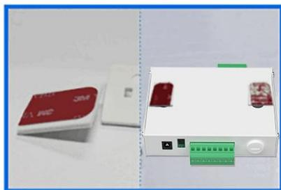
1. 将壁挂扣安置在壁挂孔上
