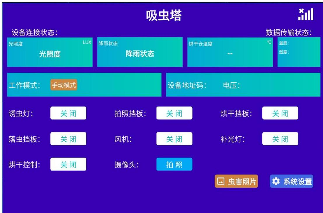
该界面可显示光照度、降雨状态、设备工作模式、设备地址码。同时可以显示当设备的运行状态，包含拍照挡板、风机等。也可以将设备调成手动模式，单独控制设备的各个部件。
