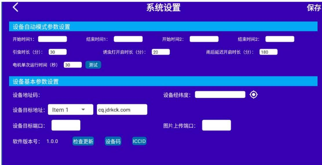
系统设置界面可以设置，开始时间、工作时长、引虫时长、诱虫灯开启时长、雨后延迟开启时长、设备目标地址、端口等参数。
