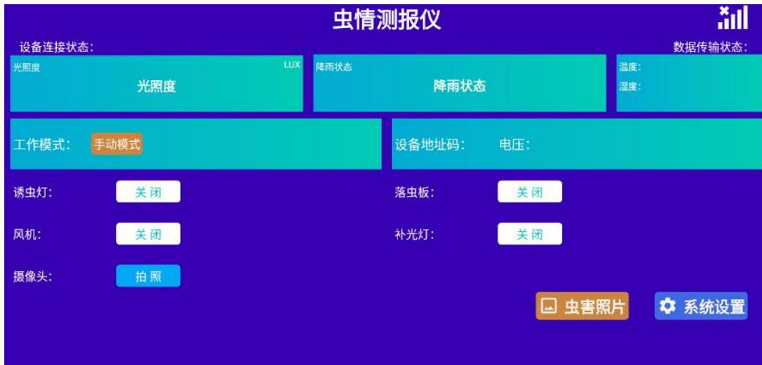
该界面可显示光照度、降雨状态、设备工作模式、设备地址码。同时可以显示当设备的运行状态，包含诱虫灯、落虫板、风机、补光灯也可以将设备调成手动模式，单独控制设备的各个部件。
