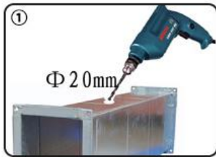
① 在非风管上打一个直径20mm的孔
