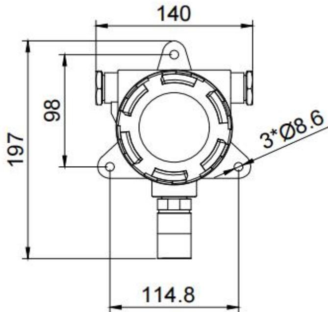
膨胀螺丝安装时，先在墙体或其它固定平面打孔，将膨胀塞放入孔内，拧入螺丝帽使膨胀塞膨胀，然后卸下螺丝帽安装设备，最后拧入螺丝帽将设备固定。
