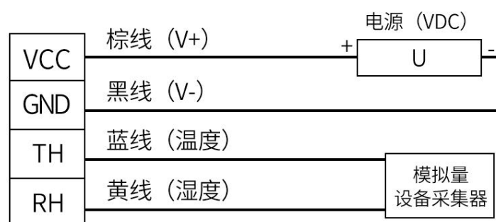
模拟量接线示意图
