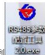
打开资料包，选择“调试软件”---“485参数配置软件”，找到
