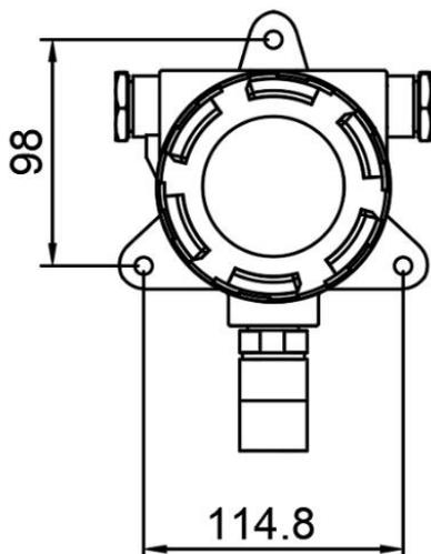
膨胀螺丝安装时，先在墙体或其它固定平面打孔，将膨胀塞放入孔内，拧入螺丝帽使膨胀塞膨胀，然后卸下螺丝帽安装设备，最后拧入螺丝帽将设备固定。
