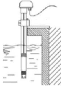
带有 NPT3/4 螺纹，可配合我司的防水管使用。线缆从管内穿出，将设备拧入防水管螺紋中。
