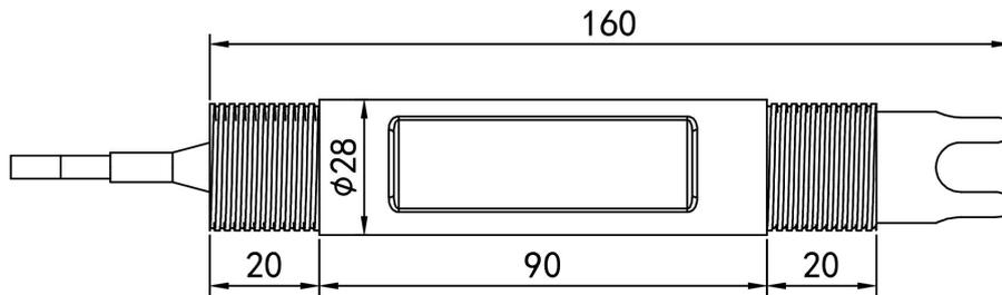
采用高纯度铂金制成的 ORP 复合电极，具有极强的抗酸碱能力和抗氧化能力，测量精度高、响应快、稳定性好，电极可根据温度自动补偿。
