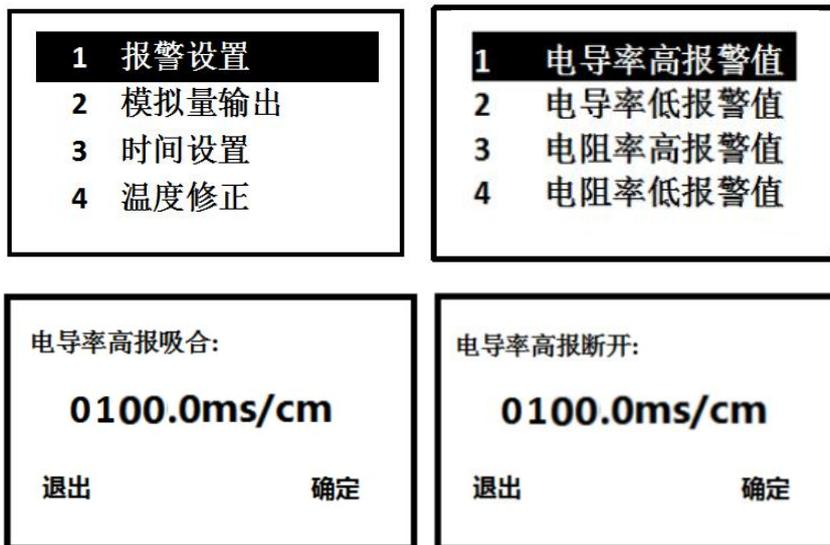
仪器报警继电器的触点是给用户连接相应的控制电器（如电磁阀等），以组成控制系统时使用的。为了避免在报警点附近继电器触点产生抖动现象，二次表里采用滞后撤消的方法。
