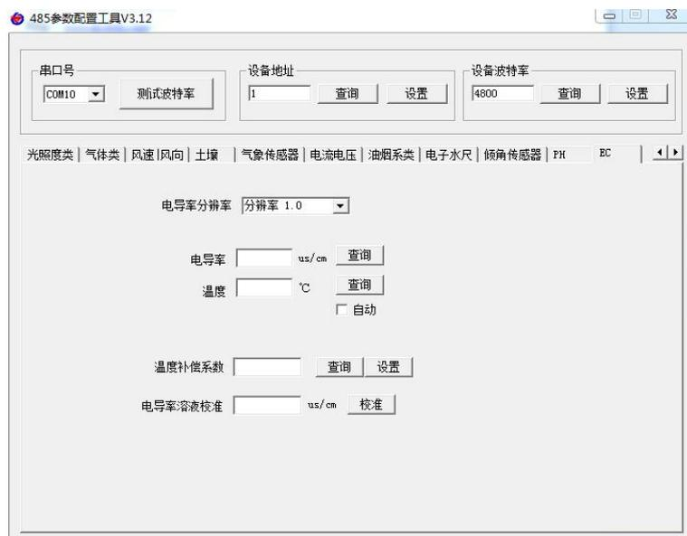
根据所购买的设备量程选择对应的电导率分辨率。若购买电极常数  $k=1$  的量程为  $1\sim 2000 \mu\text{S/cm}$  的设备，则选择分辨率 0.1；若购买电极常数  $k=10$  的量程为  $10\sim 20000 \mu\text{S/cm}$  的设备，则选择分辨率 1.0。默认分辨率为 1.0。
