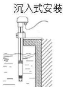
带有 NPT3/4 螺纹，可配合我司的防水管使用。线缆从管内穿出，将设备拧入防水管螺纹中。
