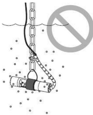
建议在传感器线缆外面装一个线缆保护套。传感器水平放置且固定牢固，测量区域迎向水流方
