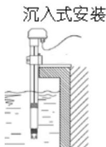
带有 NPT3/4 螺纹，可配合我司的防水管使用。线缆从管内穿出，将设备拧入防水管螺紋中。
