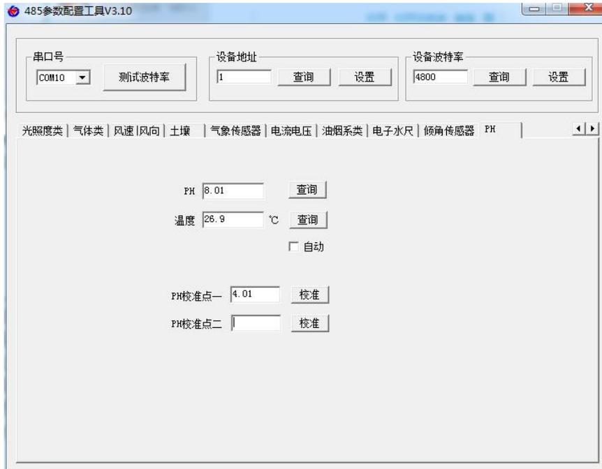
5) 第一点标定完成后，清洗 PH 电极并用纸巾或柔软布料吸干多余水分（请勿使电极玻璃球泡受损，否则电极将会失效），重新勾选自动选项，放入 PH 值相对大的标准缓冲溶液中（例如使用 4.01 和 9.18 两种缓冲液时选择 9.18），在校准点一处输入标准缓冲溶液的 PH 值，待数值稳定后取消自动，点击校准点二的“校准”标定第二点。标定完成。
