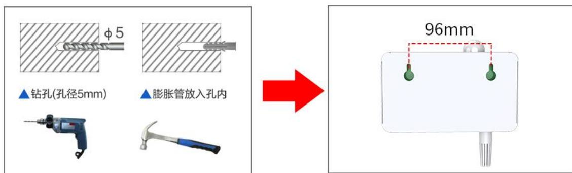
1. 在墙壁上使用钻头打入直径为5mm的两个圆孔，间距离为96mm
