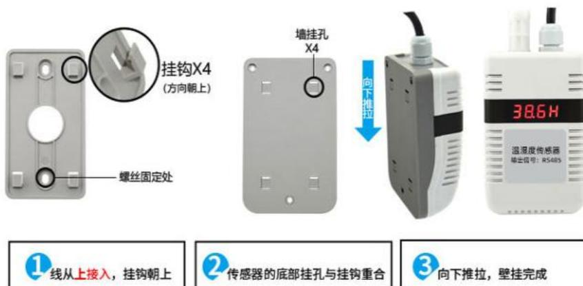
首先需要在墙体上打两个直径为 5mm 的孔，将膨胀塞安装到孔内，将底壳挂板用 M3\*25 的自攻丝固定，固定好底壳挂板之后，将设备底部挂孔与挂钩对应，向下推拉即可完成安装
