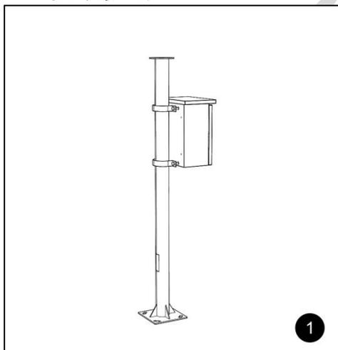
1.将配电箱使用抱箍和螺钉固定到 M1 下立杆上。
