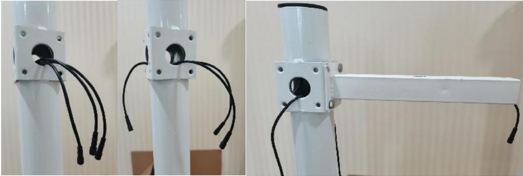
一对一接线方式：此方式适用于带集线器的箱体，也是立杆内部走线，每台设备都配有 2.5 米延长线，延长线的公头母头均贴有线标，用户将延长线公头与设备连接，另一端穿过支架放进立杆内部；立杆安装配电箱的部位做有微联孔，箱体中的防水对插线公头也贴有线标，用户使用时需将微联孔敲开，将立杆中的线通过微联孔勾出，接在配电箱内部对应线标的公头上即可完成安装。
