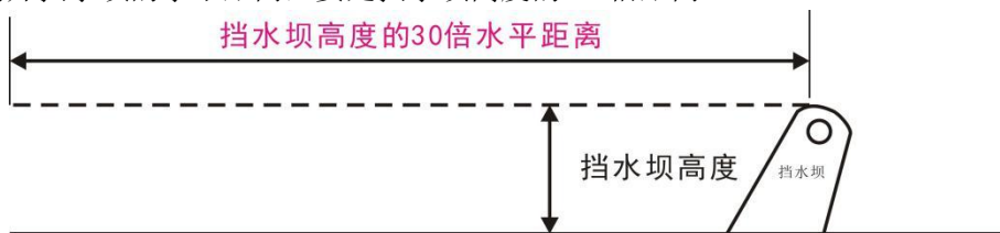
离开挡水坝高度 30 倍水平距离安装
