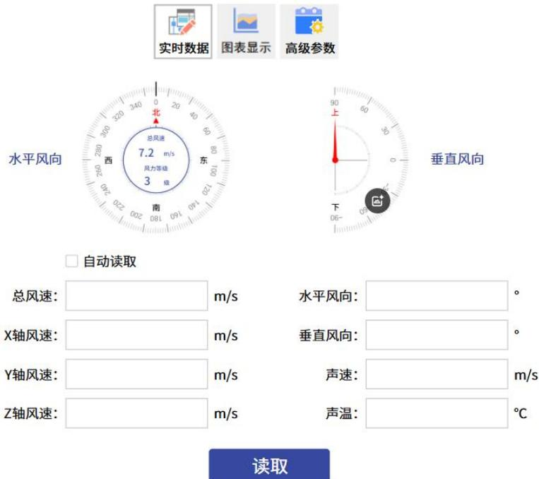
总风速：三轴矢量合成风速，即实际风速。
