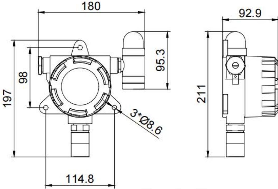
带声光报警器壳体尺寸图 (单位: mm)
