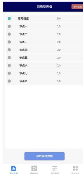
7) 底部选择基础参数, 然后根据需要读取的字典, 点击对应字典前面的复选框进行选中。点击“召唤参数”, 等待提示读取成功后, 即可看到当前读取到的参数值。同理需要更改参数时, 首先根据需要读取的字典, 点击对应字典前面的复选框进行选中。点击字典后面的文本框, 在弹出的文本框或者下拉框中输入或选择需要修改的内容, 然后点击确认。最后点击“下发参数”, 等待提示下发成功后重新点击读取查看是否修改成功。
