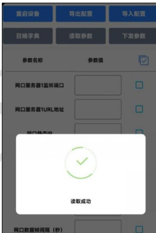
7 底部选择实时数据，然后点击右上角的“读取实时数据”，手机靠近 NFC 感应区域，等待读取成功后，拿开手机。即可看到设备显示的信号强度。
