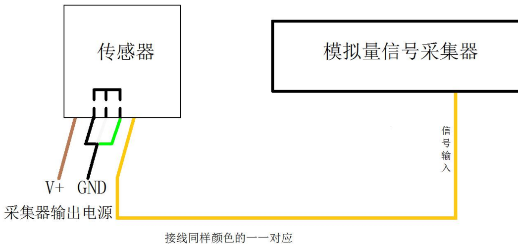
三线制接法示意图
