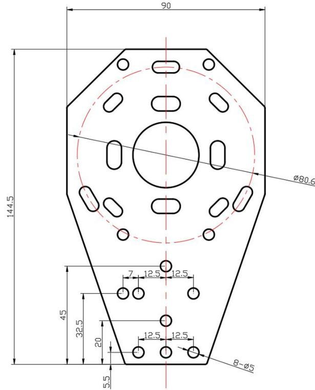
安装托板尺寸图 (单位: mm)
