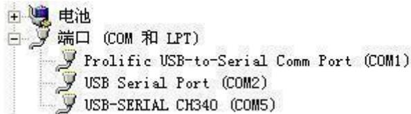
②、单独只接一台消防液位显示器并上电，点击软件的测试波特率，软件会测试出当前设备的波特率以及地址，默认波特率为 4800bit/s,默认地址为 0x01。可根据自己的需求修改地址和波特率。
