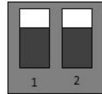
图 1 所示：拨码开关对应选择温度测量范围为 $-40\sim 80^{\circ}\text{C}$
