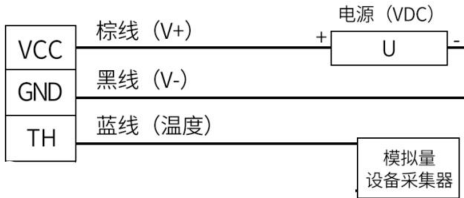
模拟量接线示意图
