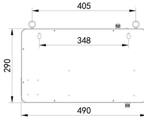
若选用葫芦孔安装，需先在墙体或其它固定平面打孔，然后安装膨胀塞和螺丝，最后将设备挂到螺丝处即可。
