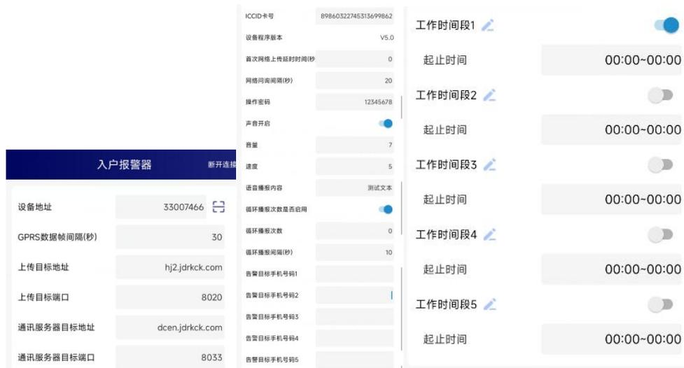
● **4G 数据帧间隔（秒）**：设备主动上送数据的间隔时间，本时间即为数据采集器更新的时间，若用户对数据的更新时间相应要求较高，则可将此时间设短，若用户想减少网络负荷，则可将本时间设长，本时间范围是 1~60000s。一般用户可设置为 30s，即设备每隔 30s 上送一次数据。（默认：30s）
