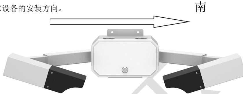
注意：将能见度传感器安装到距离地面大约 2 米的地方。保证能见度下方不要有别的物体，干扰测试。理想安装场地应距大型建筑物或其它会产生热量及妨碍降雨的设施至少 100 米，而且也要避免树荫的影响。场地应无干扰光学测量的障碍物、反射面和明显的污染源。
