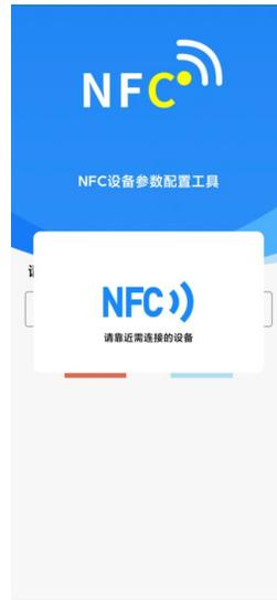
(3) 显示读取成功后，即可拿开手机，在输入框中输入密码（默认密码：12345678），然后点击确认。（下图 1）
